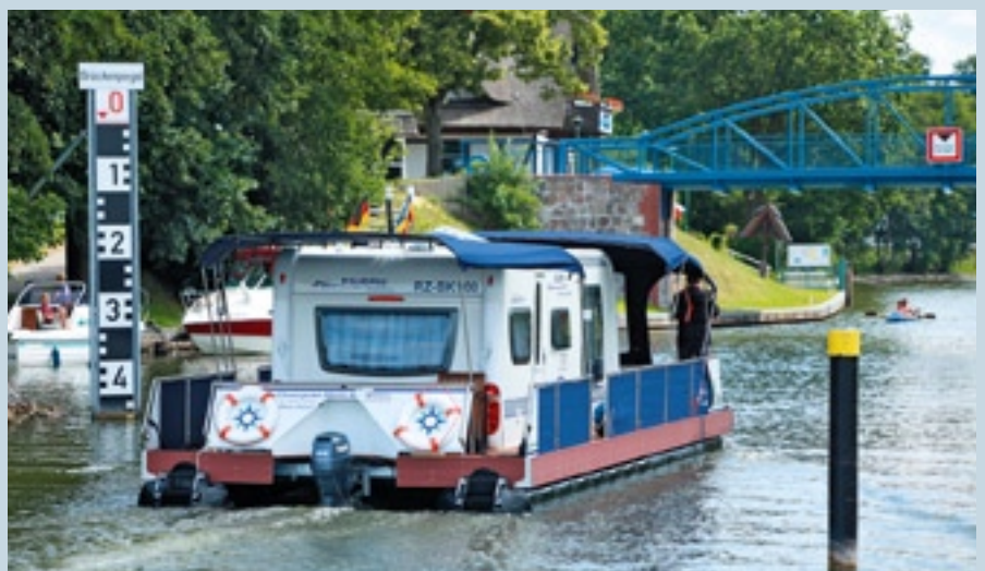
Durchfahrtshöhen sind vom Wasserstand abhängig, deshalb misst die Messlatte nach unten
